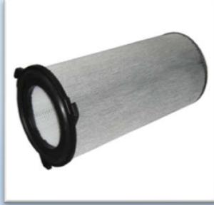
Фильтрующие картриджи изготовлены из гофрированной ткани из полиэстера обработанного алюминиевым порошком, что гарантирует снятие статического заряда с частиц пыли. Нефильтрованный остаток пыли составляет менее 0,1% с размером частиц от 0,2 до 2 мкм. Фильтра обладает отличной стойкостью к органическим растворителям, и имеет максимальную температуру в продолжительном режиме работы до 150°C. Гладкая поверхность фильтра позволяет получить оптимальное отлипание пыли при очистке.
