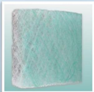
Фильтр “Paint-stop” состоит из слоев стекловолокна, соединенных между собой синтетической смолой, имеет прогрессивную плотность в направлении движения воздуха. Обладает высокой пыленакопительной способностью, устойчив к высоким температурам. В основном применяется для сбора излишков краски при нанесении методом распыления.
