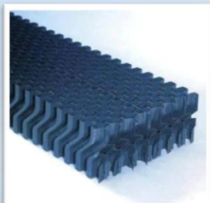
Каплеулавливатель предназначен для вертикальных и перекрестных воздушных потоков, изготовлен из прессованных листов ПВХ. Геометрия с двойной сменой направления потока. Высокое качество ПВХ обеспечивает отличную стойкость к неорганическим химическим веществам.
