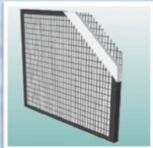
Этот синтетический фильтр используется для фильтрации пыли. Состоит из термовспененных волокон полиэстера, обладает высокой эффективностью задержания пыли при низкой потере давления. Нетоксичный, инертный к химическим продуктам и микроорганизмам.
